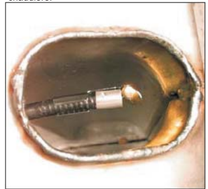
Inspection rapide et complète de l'échangeur thermique avec le miroir à 45° (option)
